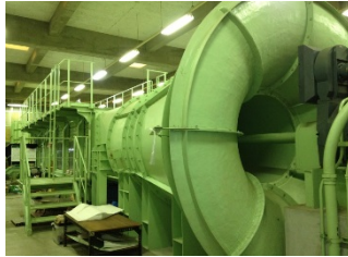
写真1 森林総合研究所の風洞装置 風速は最大40m/sまで発生可能 (全長27m 測定部は幅1.2m×高1.6m×長10m)
