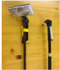
▲長尺自撮り棒はカメラ用の三脚に測竿や釣竿を装着しセルフタイマーで撮影します。
