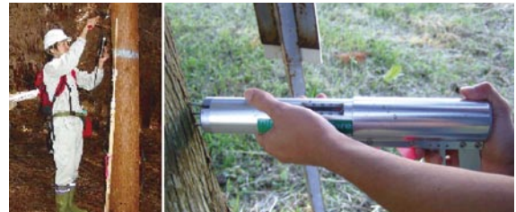
写真 (左)応力波伝播速度の測定、(右)ピロディン陥入量の測定
