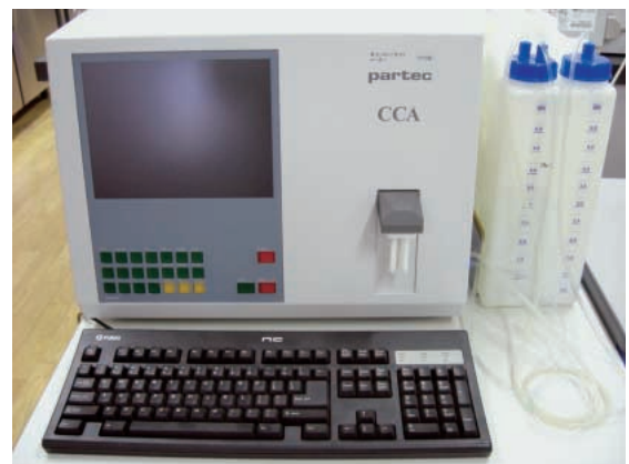
写真-1 簡易型フローサイトメーター
