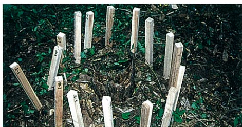
写真-4 木部の白蟻・腐朽等に関する試験の様子
