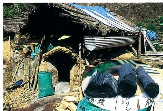
写真-6 モリシマアカシア木炭を生成した炭焼き窯（天草森林組合所有の窯。円内は同時に焼いた炭で、左からシイ、モリシマアカシア、カシの順。）
