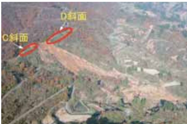
写真-4 中越地震時の斜面崩壊 （写真提供、落合博貴）
