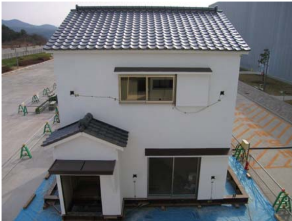
鉄骨架台の上に建つ試験体
