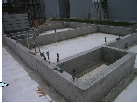
地盤は発泡系プラスチック材料で模擬
