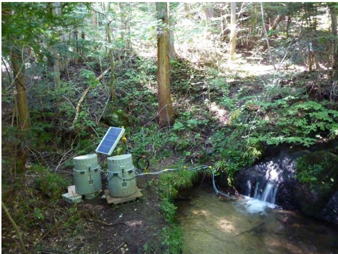
写真1 調査地の様子 定時採水用の装置（右）に加え、降雨時採水用の装置（左）を追加しました。
