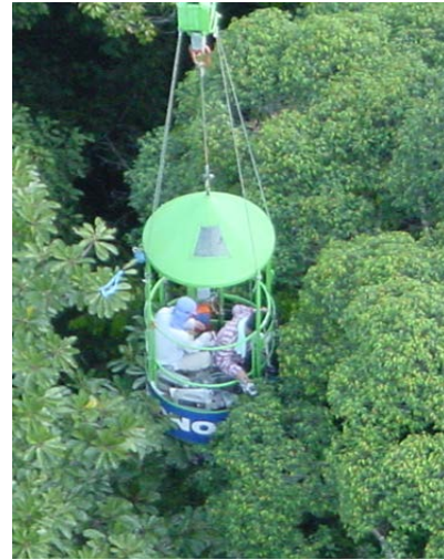
写真2 林冠観察用クレーンのゴンドラに乗り、地上から約40mの高さで測定している
