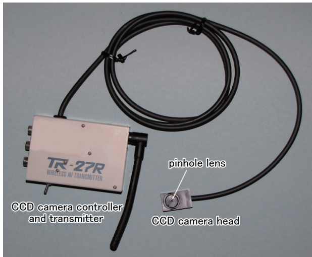
Photo 1. 小型 CCD ビデオカメラ（カメラヘッド部とカメラコントロール部の分離型。カメラコントロール部に映像信号送信機を内蔵） Remote-head wireless miniature CCD video camera, with the transmitter built into the camera controller.
