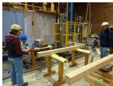
製材品の動的ヤング係数の測定
