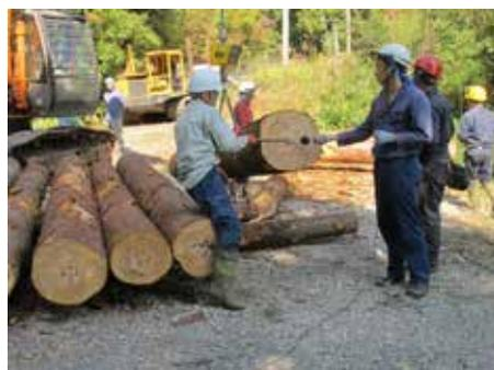
原木丸太の動的ヤング係数の測定
