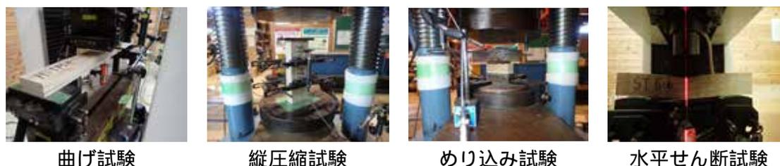
図 5-8 LVL の強度試験
