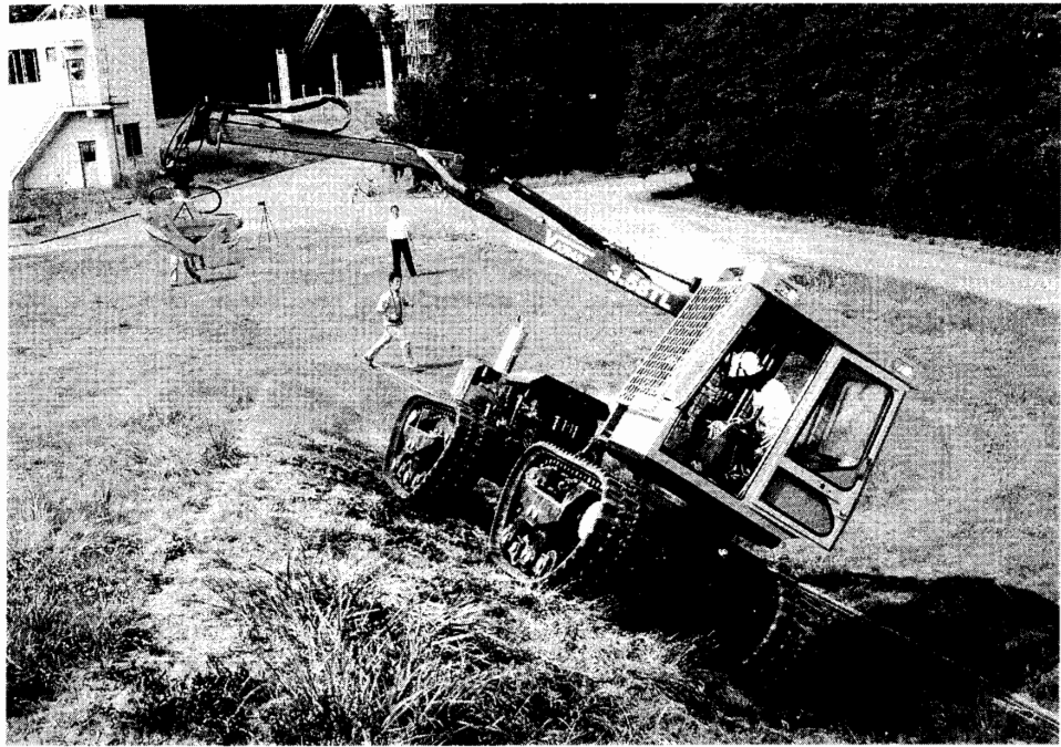
図 3. 連結装軌車両 2 号機 (5 自由度ジョイントにより斜め方向移動が可能)
