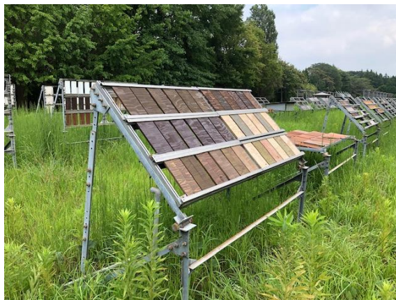
図1 合板小試験片の屋外暴露試験
