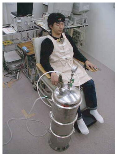
写真3 人工気候室内における木材の香り成分の吸入実験風景
