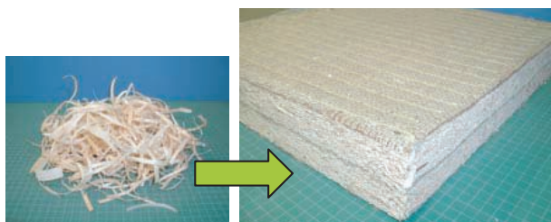
写真2 ヒノキチップ（左）とヒノキ畳（右） （ヒノキチップを圧縮、成型、縫製することによって畳床を作製します。畳床に畳表（イグサ）と縁（ヘリ）をつければ畳が完成です。）
