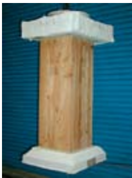
写真1 耐火試験用の試験体
