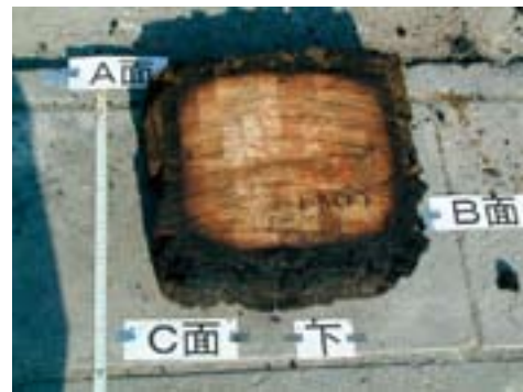
写真3 難燃処理した木材を積層した集成材は燃え止まった
