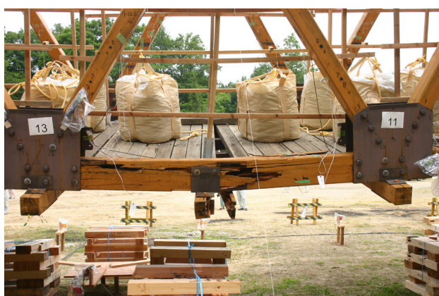
写真4 上流側下弦材の破断 (最初の破壊)
