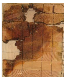
写真6 部材の断面内含水率分布と切断面 左から最初の破壊箇所、最終破壊箇所、健全部材
