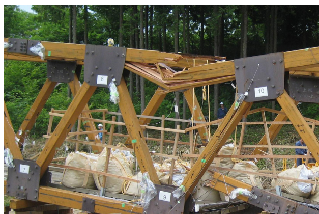
写真5 下流側上弦材の圧壊 (最終破壊)
