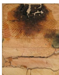
写真6 部材の断面内含水率分布と切断面 左から最初の破壊箇所、最終破壊箇所、健全部材
