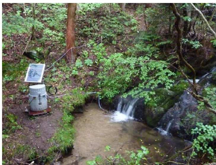
写真1 採水装置 一定の時間間隔で自動的に渓流水を採取する装置を使用しました。
