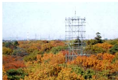
写真 森林-大気間の熱エネルギーや二酸化炭素の流れを観測する タワー
