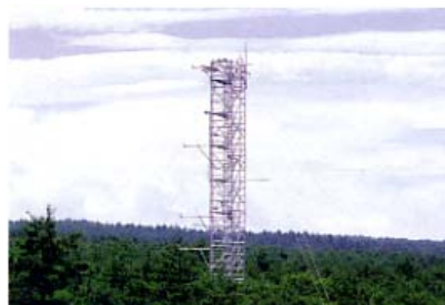
多様な森林の二酸化炭素吸収量を評価し、変動を予測するための観測研究が世界中で行われている。微気象学的方法（渦相関法）を用いて、森林-大気間の二酸化炭素交換量を測定するための観測タワー（森林総合研究所富士吉田森林気象試験地）
