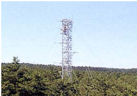
大気-森林間のCO 2 輸送量の観測（観測タワーを用いた渦相関法による測定、富士吉田サイト）
