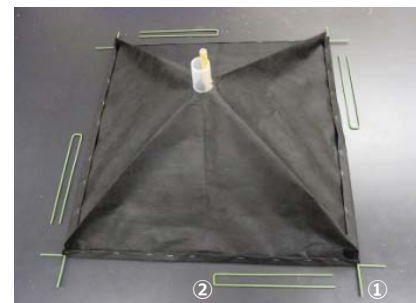
図22. 設置されたテント。①押え棒、②ペグ
