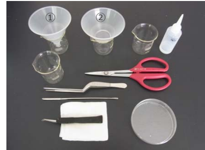
図31. シャーレの移し替えに必要な器材。①無脚ロート、②網付ロート
