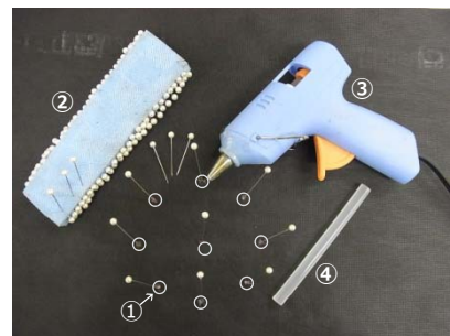
図28. トラップカバーの針刺し台座の作製。①台座（白丸）、②玉針を刺し込んだポリエチレンフォーム、③ホットグルーガン、④グルースティック
