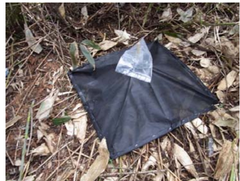
図9. 改良型羽化トラップ。初期モデル（図1）の捕獲容器とペグを、携行に適した仕様に変えたと共に、テントの生地を黒に変え、目立ちにくくした。
