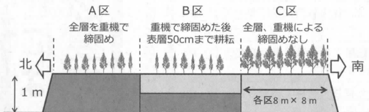
図1. 陸前高田市小友地区の試験植栽地の断面構成図 ※盛土面積：600.0㎡、盛土量：562㎡、防風柵：136m、 苗植栽本数：384本（アカマツ192本、クロマツ192本）
