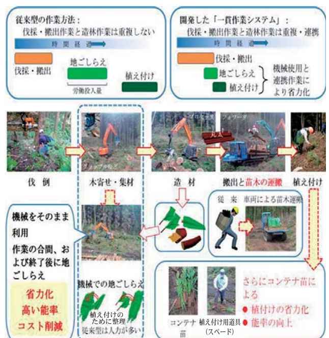
図-1 伐採—造林の一貫作業システム （森林総合研究所林業工学研究領域作成ポスターより）
