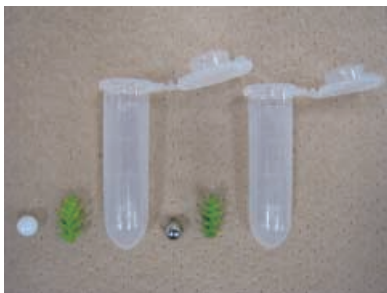
写真-1 サンプル破碎用のチューブとボール (左:ジルコニアボール、右:ステンレスボール)
