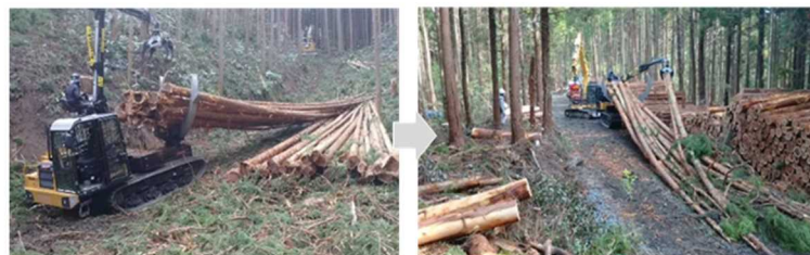
ゴムクローラ式クラムバンクスキッドとそれを用いた全木集材作業
