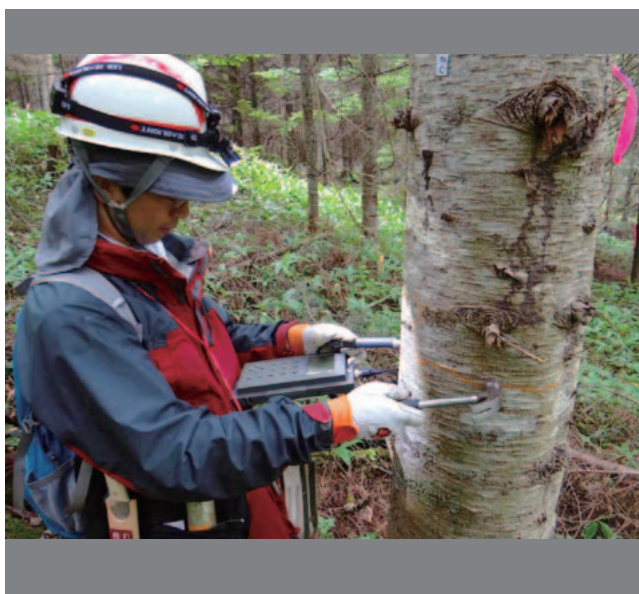
トドマツの材質非破壊試験（横打撃共振法）による選抜の効率化
