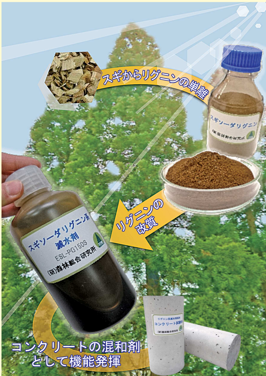
図1 スギソーダリグニンから減水剤の開発
