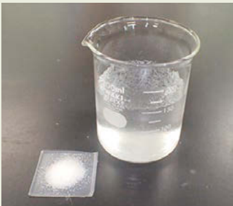
殺虫剤液剤と砂糖を水に溶かし高吸水性ポリマー（左下の粉末）に吸わせて作成した毒餌剤ハイドロジェルベイト剤。
