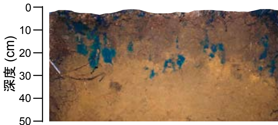
図2 土壌が乾いたときに青色の色素を含む水を散布すると、水は均一に下層へ浸透せず、根の周りのすき間などのマクロポアを選択的に流下します。
