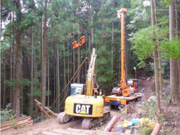
図1 集材作業の状況 (手前: プロセッサ、奥: タワーヤーダ) プロセッサのコックピットからリモコン操作して、タワーヤーダの搬器を操作している様子。
