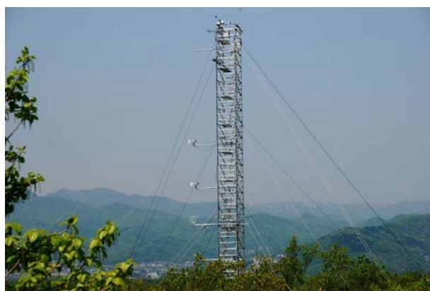
図2 タワーを用いた二酸化炭素(CO 2 )吸収量測定の様子 森林の樹冠より数m~十数m上で測定した様々な観測データからCO 2 吸収量を求めます。
