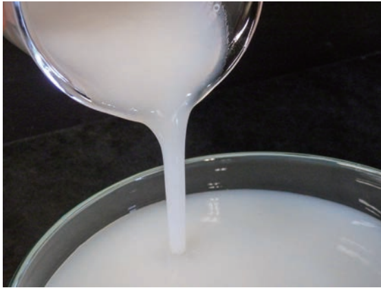
図1 セルロースナノファイバー懸濁液 CNFは、乾燥させると繊維同士が固着して、再分散しなくなるため、水に懸濁させた状態で製造されます（写真はCNF2.4%含有）。
