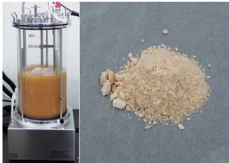
図3 ジャーフェルメンターによるシドウィア菌培養の様子(左)と乾燥粉末化したシドウィア菌の胞子(右)
