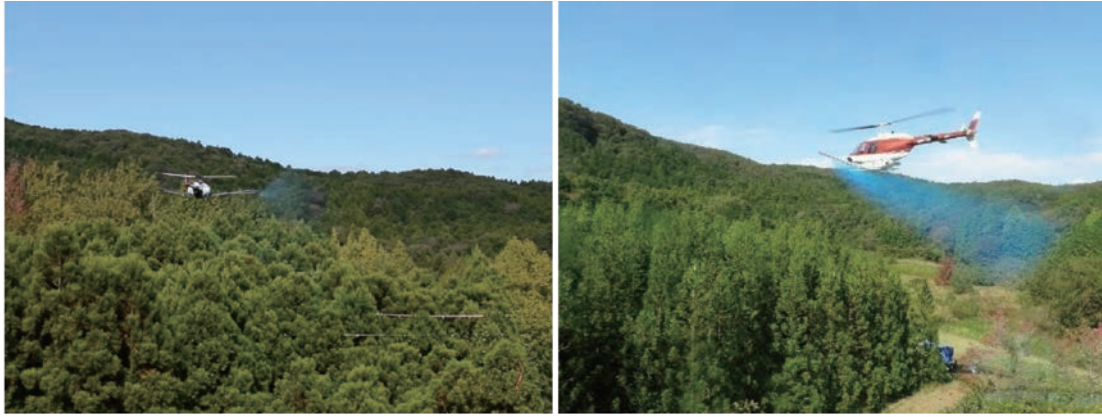
図1 無人ヘリコプター(左)と有人ヘリコプター(右)によるスギ花粉飛散防止剤の空中散布 ヘリコプターのノズルから射出されている青色の霧は防止剤に青色の食用色素を混ぜたもの
