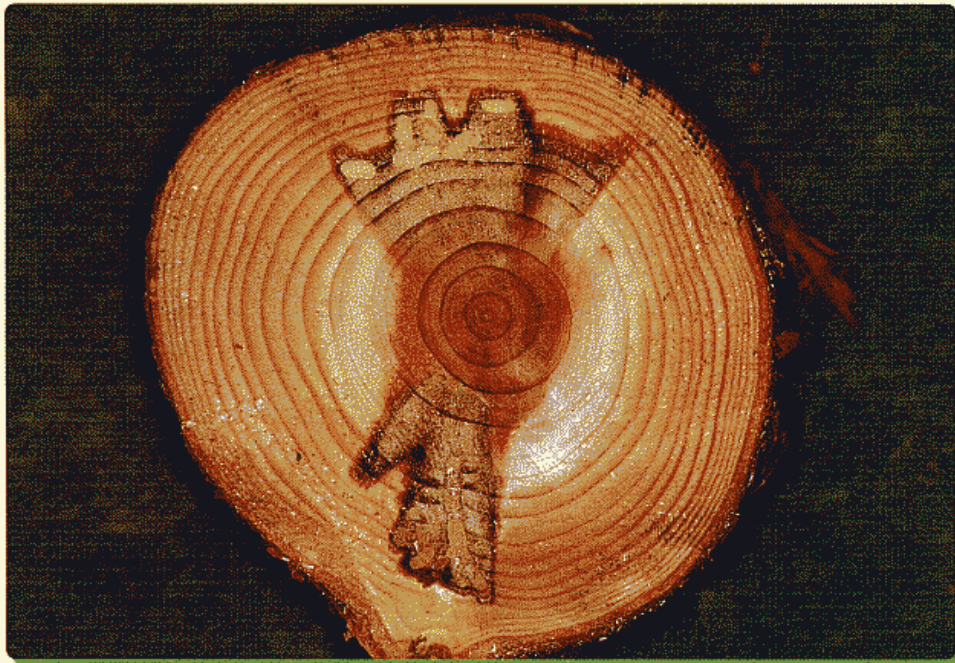
写真1 スギ丸太の木口に現れたトビクサレ
