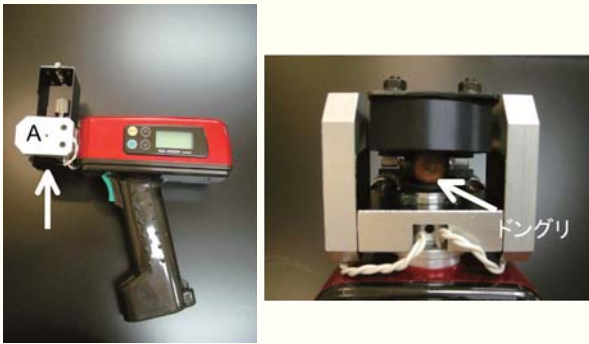
写真3 ドングリ測定用近赤外分光器 右図は測定の様子（左図のAの部分に矢印方向から見る）
