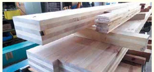
写真4 試験用に作成されたアカマツCLT。強度試験に使用するため、作成したパネルを縦長に切断加工してあります。
