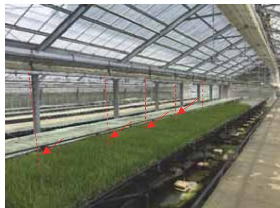
写真. 灌水部から下に紐を下げて水滴の通り道を確認している例（赤点線）
