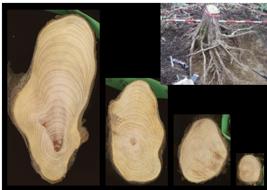
図1 ヒノキの根と年輪 (A)、根の伸長速度と土壌の軟らかさ指標 (S 値) (B)。S 値は、一定条件の打撃を与えることで、先端の尖った金属棒が土壌に貫入する深さ。
